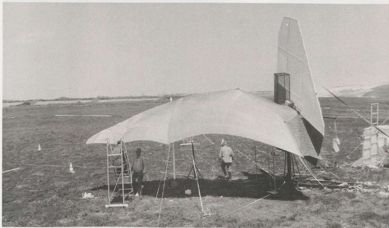
La demi-aile gauche, en cours d'installation à Beaumont (campagne 1987). La grande cloison verticale, à droite, assure la régularité de l'écoulement selon une direction parallèle à l'axe du fuselage.
