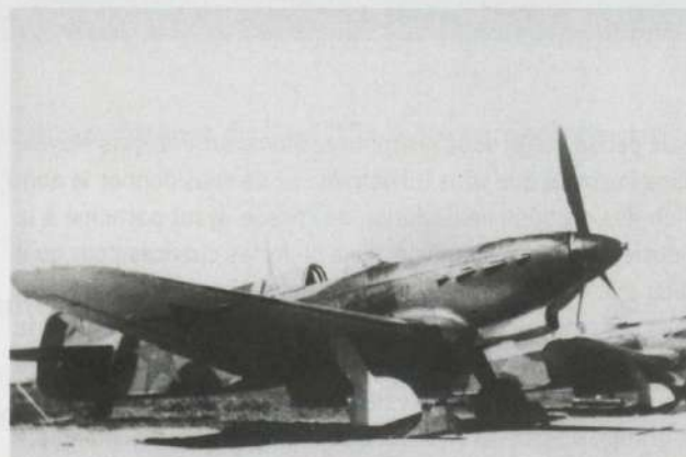
Un Yak 1 : MA 2424. Remarquer la buse d'admission d'air, bien visible sous le nez de l'appareil.
