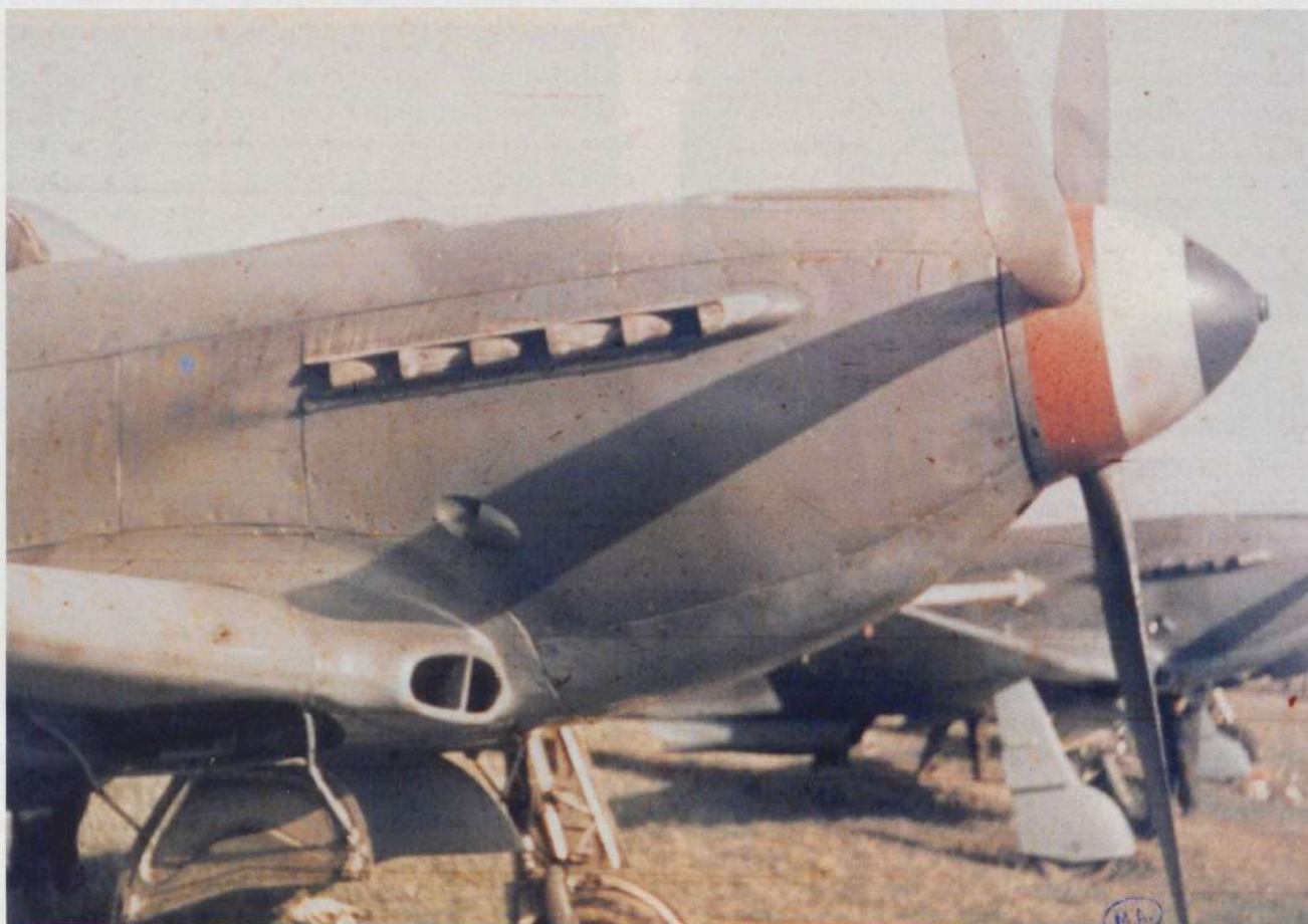
Sur le Yak 3 du Musée, on voit bien que la buse d'admission d'air est maintenant placée à l'emplanture des ailes. MA15024.
