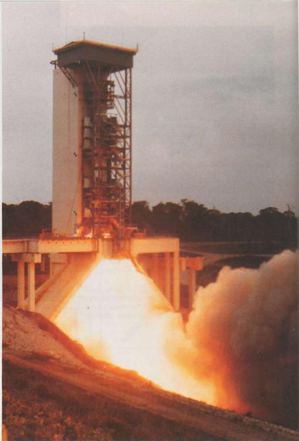
*Essai au banc au Centre Spatial Guyanais de Kourou du premier prototype des accélérateurs à poudre d'Ariane 5 en février 1993 (Photo CNES).*
