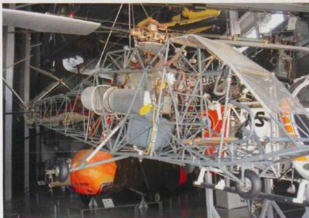
Hélicoptère SE 3101 exposé dans le hall des voilures tournantes au Musée de l'Air et de l'Espace. Remarquer la simple construction en tubes métalliques. Photo J-P Reynaud.
