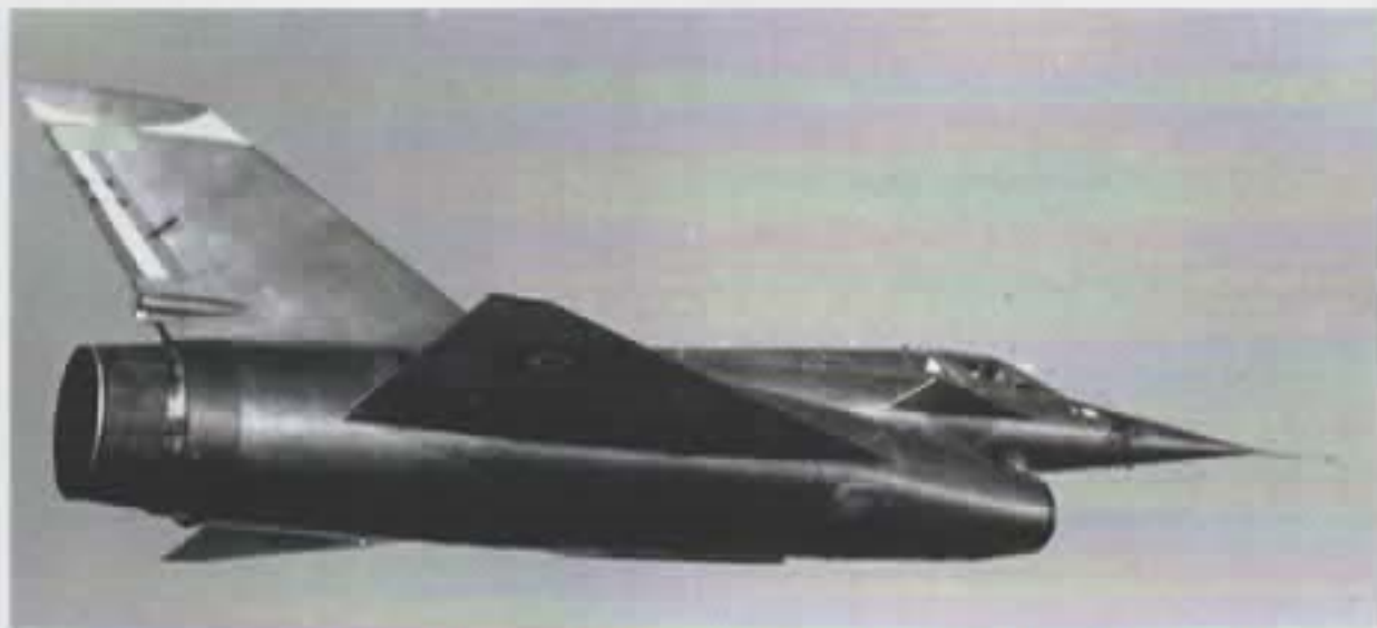
En vol, le diamètre monumental du double réacteur du Nord 1500-02 Griffon II © Photo ECPAD
