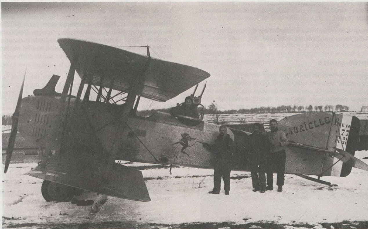
Le Breguet 14 A 2 : avion né de la formule du rayon d'action, en 1916.
