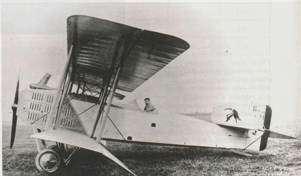
faudra faire des efforts pour obtenir la vitesse de 180 km/h demandée à 3 000 mètres. En l'attente d'une version plus puissante du moteur 12 Fcx, une vitesse plus grande peut être obtenue en réduisant un peu la traînée aux dépens de la surface de la voilure.
