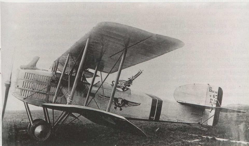
Photo MA 35513 : automne 1917, un des premiers Breguet 14 A2 à voilure de 52 m<sup>2</sup>, le Bre 675, mis en service à l'escadrille BR 7. La tourelle TO1bis est encore montée, mais elle porte déjà un jumelage de mitrailleuses Lewis, imposé dès le mois d'août aux avions « fortement armés ». Le « baigneur-porte-bonheur » accroché au mât de la seconde travée, ajoute à la sécurité de cet armement renforcé... L'insigne de l'escadrille est un cor de chasse sur une paire d'ailes déployées.
