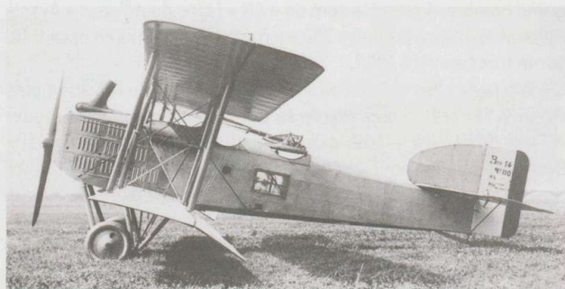
MA 13494 : Un Breguet XIV B2. Remarquer les volets en position basse et le panneau transparent au niveau de la cabine du bombardier.
