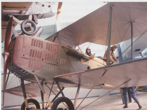
Le Breguet XIV du Musée, remarquer le tuyau d'échappement en forme de corne de rhinocéros sur le dessus du capot moteur. Au plafond, on distingue le DH 9. (Photo A.A.M.A)
