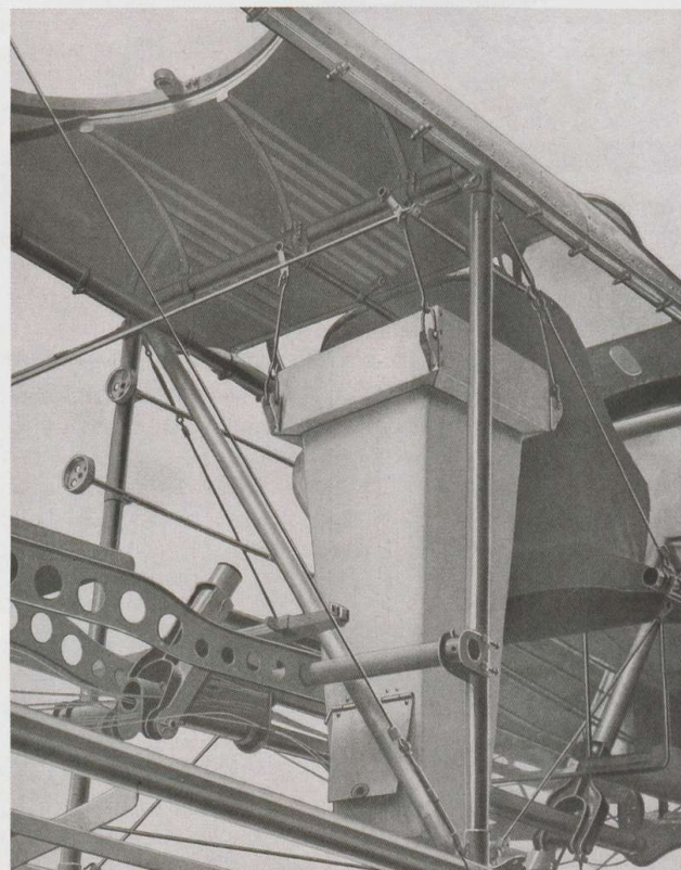
MA 37716 : le montage d'une caméra de focale 50 centimètres.
