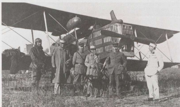
MA 28562 : Un Breguet XIV T. Remarquer les réservoirs d'essence sous les ailes hautes et la présence d'une seule cabine.
