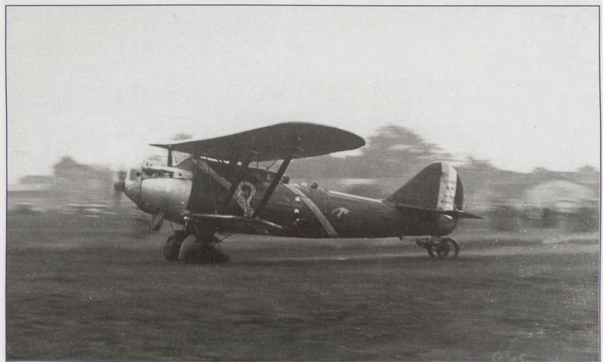
▲ Le «Point d'Interrogation» au décollage du Bourget. Remarquez le petit chariot que Costes avait fait placer sous la béquille arrière, pour faciliter le roulement au décollage.(MC 24883)
