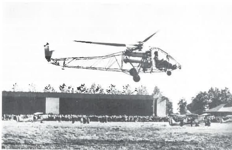
SE 3101 avec un rotor principal et deux rotors de queue en V (1948)
