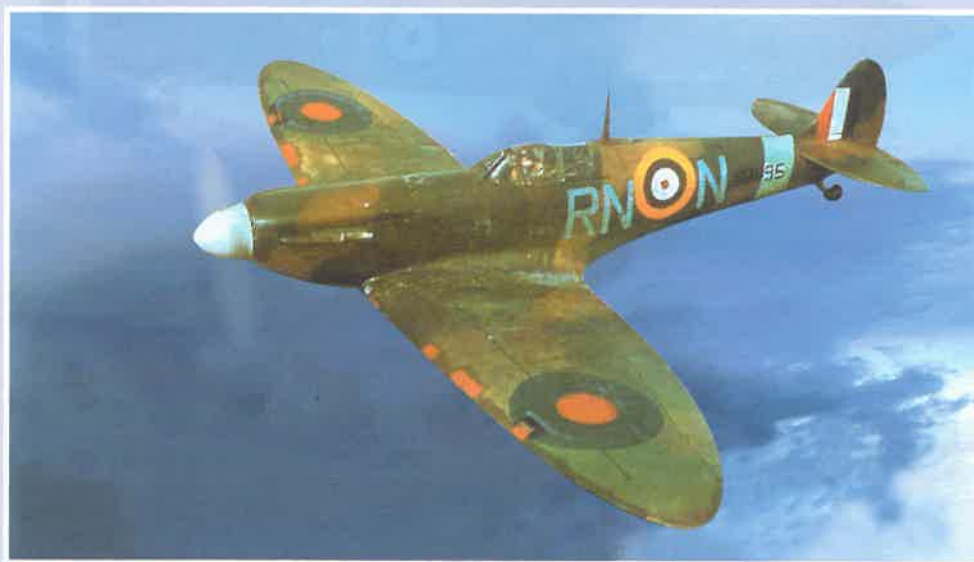
Le Supermarine Spitfire (un des premiers avions entièrement métalliques construits au Royaume-Uni) présentait d'excellentes qualités en aérodynamique et mécanique du vol.
