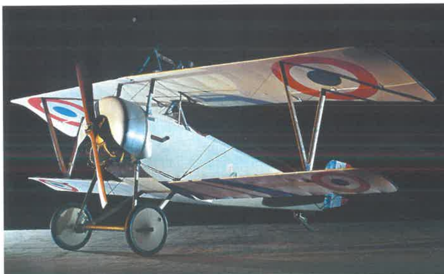
FIG. 10. – Le Nieuport XI, équipé d'un moteur rotatif, le Rhône de 80 CV, et d'une mitrailleuse Lewis (au-dessus de l'aile supérieure).
