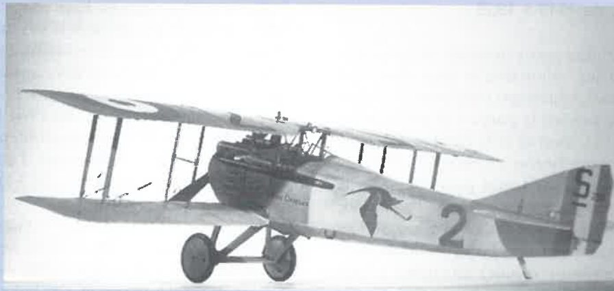
FIG. 11. – Le Spad VII de Georges Guynemer. Cet excellent appareil, dessiné par Béchereau, était équipé du meilleur moteur de l'époque, l'Hispano de 150 ou 180 CV, conçu par Birkigt.
