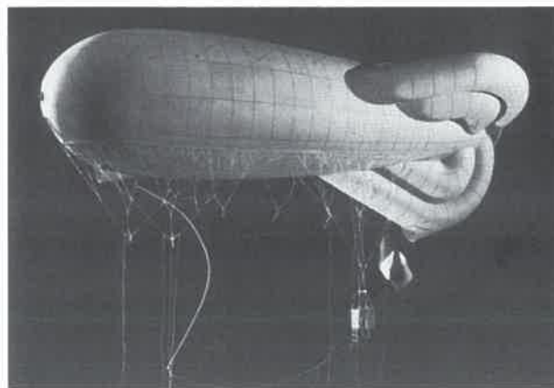
Fig. 6. – Ballon fuselé captif conçu par Albert Caquot et destiné à l'observation pour l'armée et la marine
